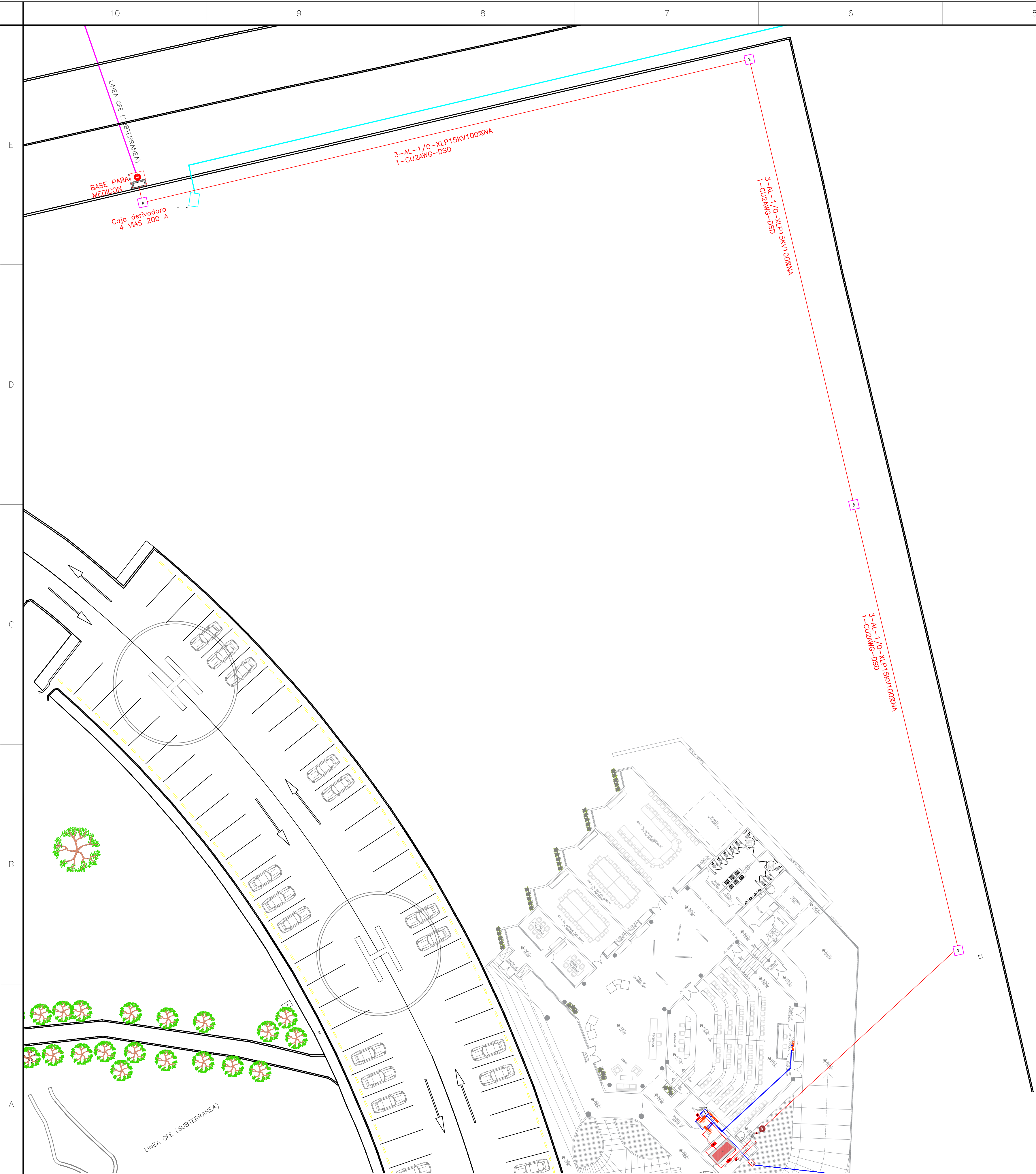
PLANTA DE CONJUNTO – DISTRIBUCIÓN DE LÍNEA Y REGISTROS ESCALA: S/E
